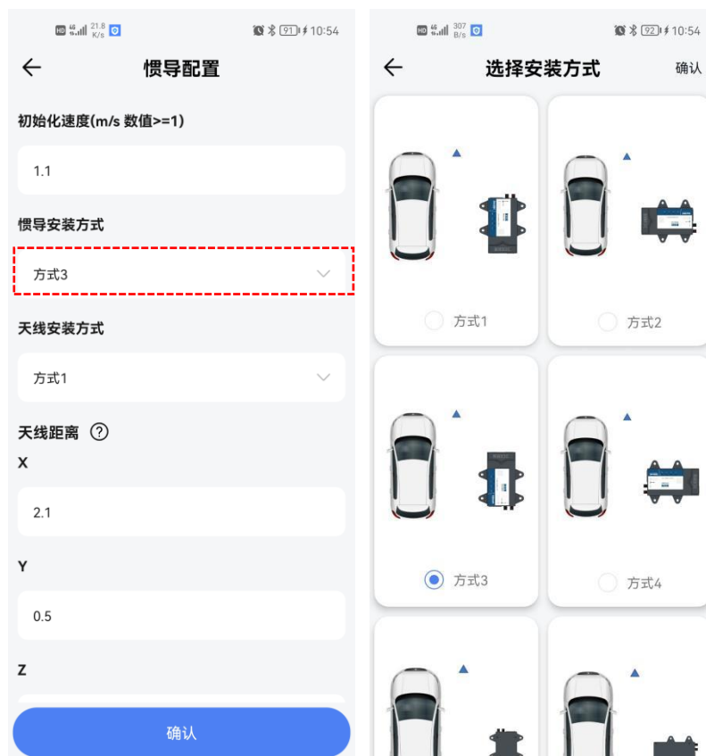
图 17.惯导安装方式配置
